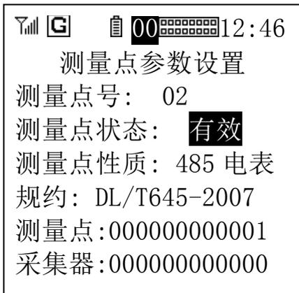
通过“↑”“↓”键选择所需要修改的数据项，通过“←”“→”可翻页，按“确定”对所选择的数据项进行修改，数据设置好后，按“取消”弹出保存确认窗口，选择确定后，即可完成本测量点的参数设置。
