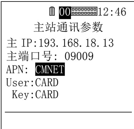
设置 APN 等含有 ASSIC 码的参数时，按“↑”“↓”会出现如上图所示的字符输入界面。这时需通过“←”“→”“↑”“↓”依次选择所要输入的字符，然后按“确认”键逐个输入。当参数输入完成后，需要在选择窗（软键盘）选定“确定”按“确认”键来退出字符输入界面。如果输入参数之时，参数后面出现过长的参数或非法字符，可以选择“清空”来快速清空字符。
