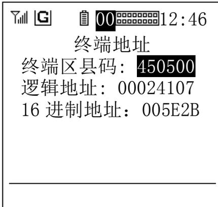
如上图所示，选择“终端区县码”参数按“确认”键后，进入的是“终端区县码设置”的页面。通过“←”“→”来移动下划线选择需要修改的数字，通过“↑”“↓”选择设置的数字的大小，再按“确认”键就可以完成当前参数的设置；“逻辑地址”设置与“终端区县码设置”相同，不同的是逻辑地址设置可按十进制设、也可按十六进制设置，任意设“逻辑地址”（十进制）或“十六进制地址”；设一个的同时另一个自动同步修改。
